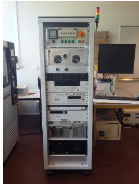
Banc d'alimentation RADAR
