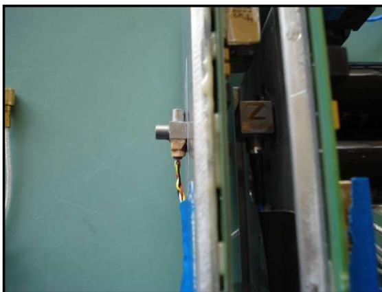
Capteur mono-axial sur MOSFET in Housing
